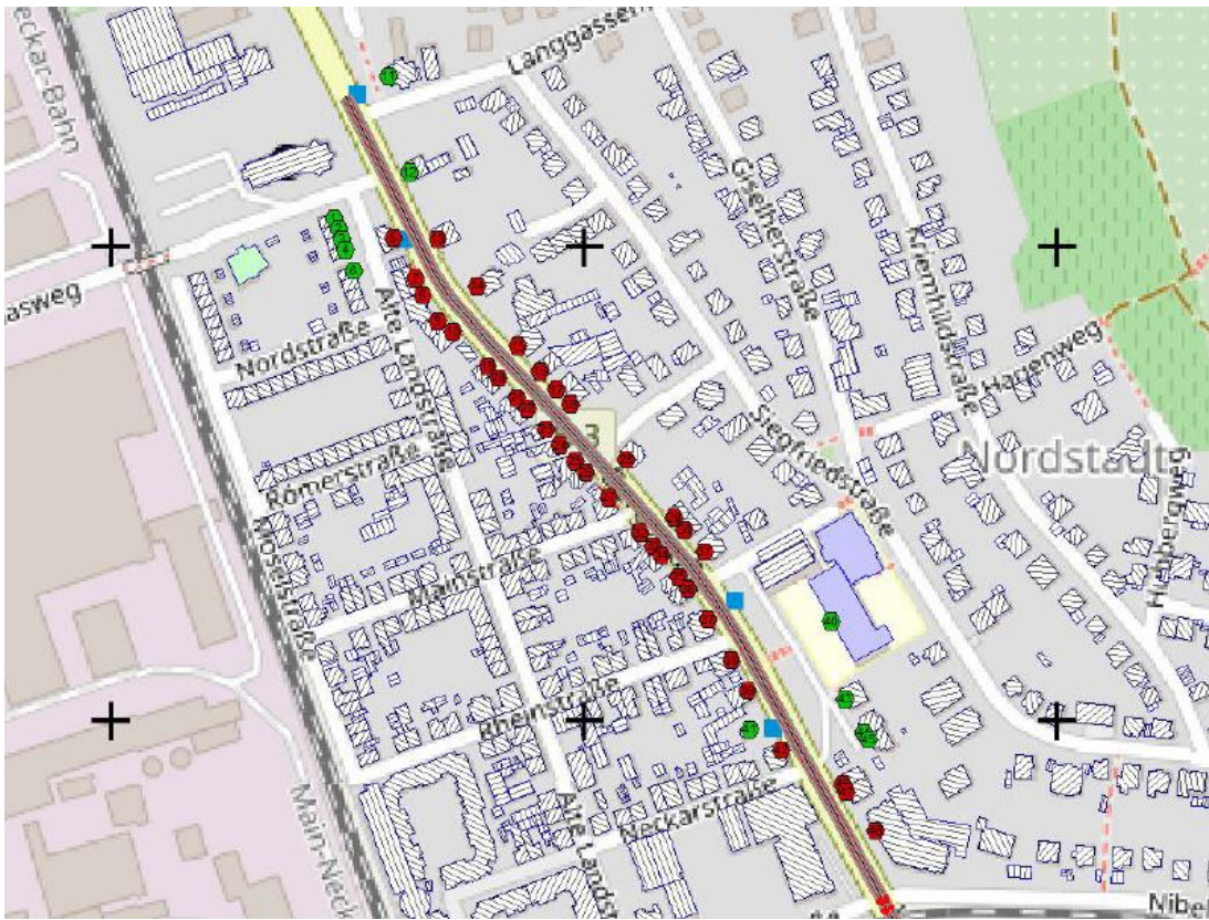
Abbildung 1: Übersicht Berechnungsergebnisse B 3 (Langmaasweg – Nibelungenstraße) Beurteilungszeitraum Tag bei v = 50 \text{ km/h} (Bestand) / zugrunde liegender gesundheitskritischer Richtwert für Überschreitung: 65 \text{ dB(A)} / grün: Richtwert eingehalten / rot: Richtwert überschritten
