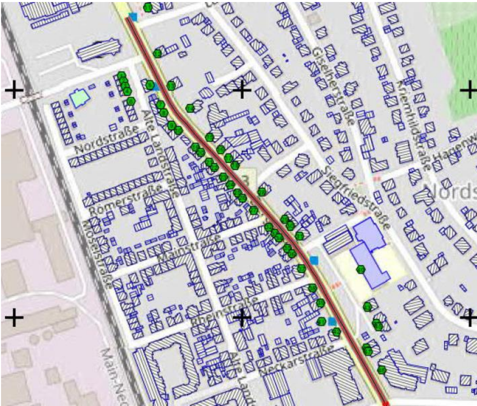
Abbildung 6: Übersicht Berechnungsergebnisse B 3 (Langmaasweg – Nibelungenstraße) Beurteilungszeitraum Nacht bei v = 30 \text{ km/h} (PLANUNG) / zugrunde liegender gesundheitsschädlicher Richtwert für Überschreitung: 60 \text{ dB(A)} / grün: Richtwert eingehalten / rot: Richtwert überschritten
