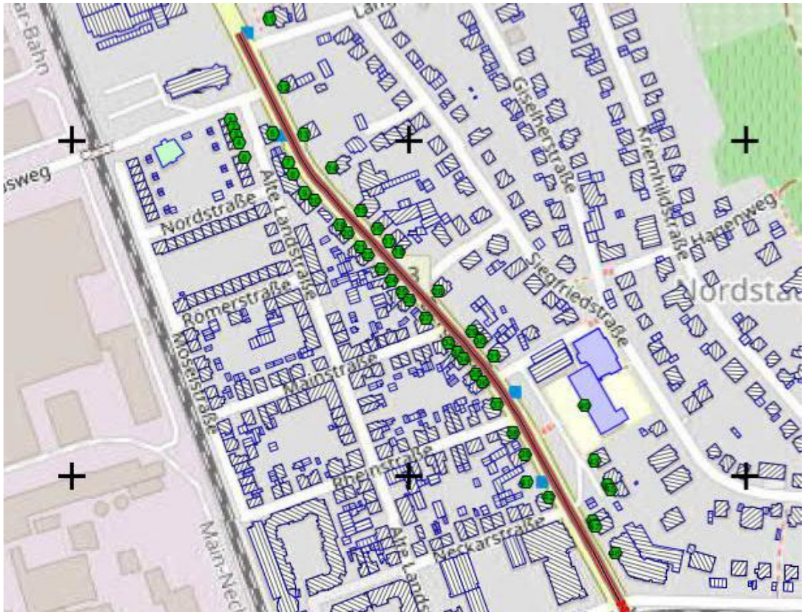
Abbildung 20: Übersicht Berechnungsergebnisse B 3 (Bergstraße) Beurteilungszeitraum Nacht – v = 30 km/h (Plan), nördlicher Teil- Bewertung nach der Gesundheitsgefährdung
