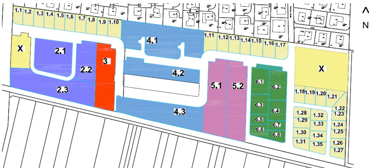
**Abbildung 1: Unterteilung des Neubaugebietes „Allmendäcker“ in Baufelder, Unterbaufelder und bei Baufeld 1 in einzelne Bauplätze**
