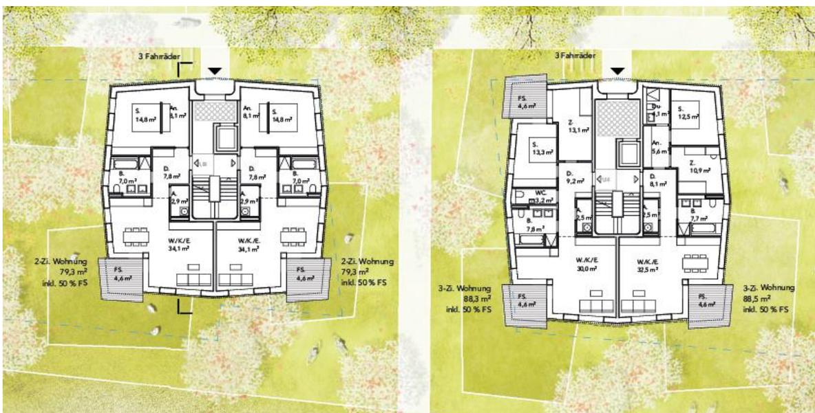
Abbildung 4: Grundriss zweier Punkthäuser in Baufeld 4.3 zur Verdeutlichung der polygonalen Form
