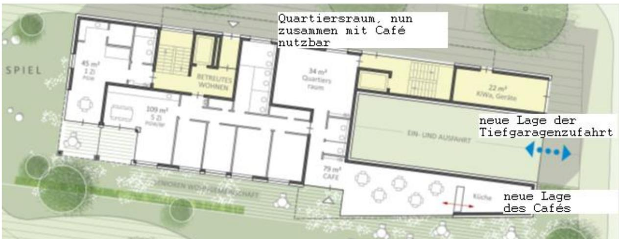
**Abbildung 12: Grundriss des östlich gelegenen Gebäudes in Baufeld 4.2 mit geänderter Lage der Tiefgaragenzufahrt und des Cafés (Werkgemeinschaft HHK Architekten GmbH)**
