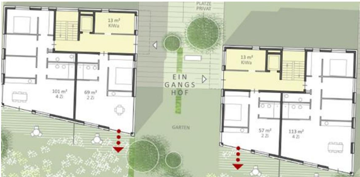
**Abbildung 13: Grundriss zweier Punkthäuser in Baufeld 4.3 mit der veränderten Geometrie und der neuen Eingangssituation (Werkgemeinschaft HHK Architekten GmbH)**
