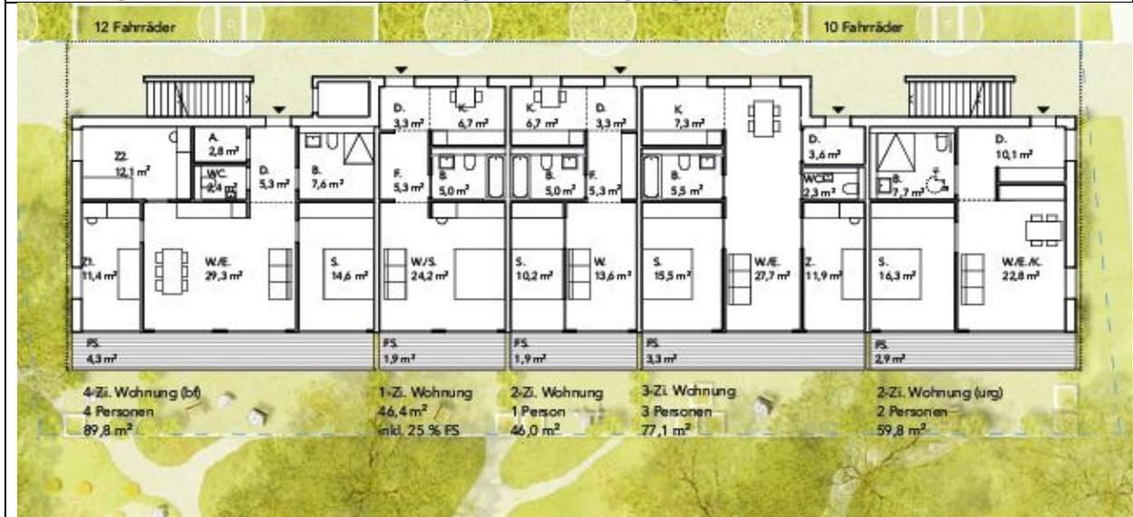
Abbildung 5: Grundriss EG östlicher Riegelbau
