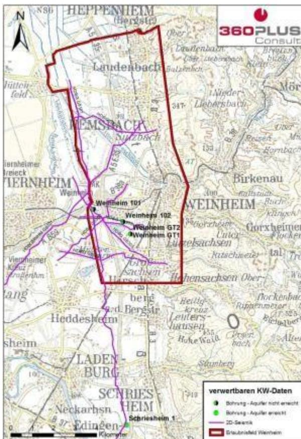
Vorliegende Studien gehen davon aus, dass ausreichend Thermalwasser mit einer Temperatur von ca. 160°C in rund 3.800 m Tiefe zur Verfügung steht und damit die geothermischen Voraussetzungen zur Nutzung von Erdwärme im Bereich Weinheim als positiv zu werten sind.
